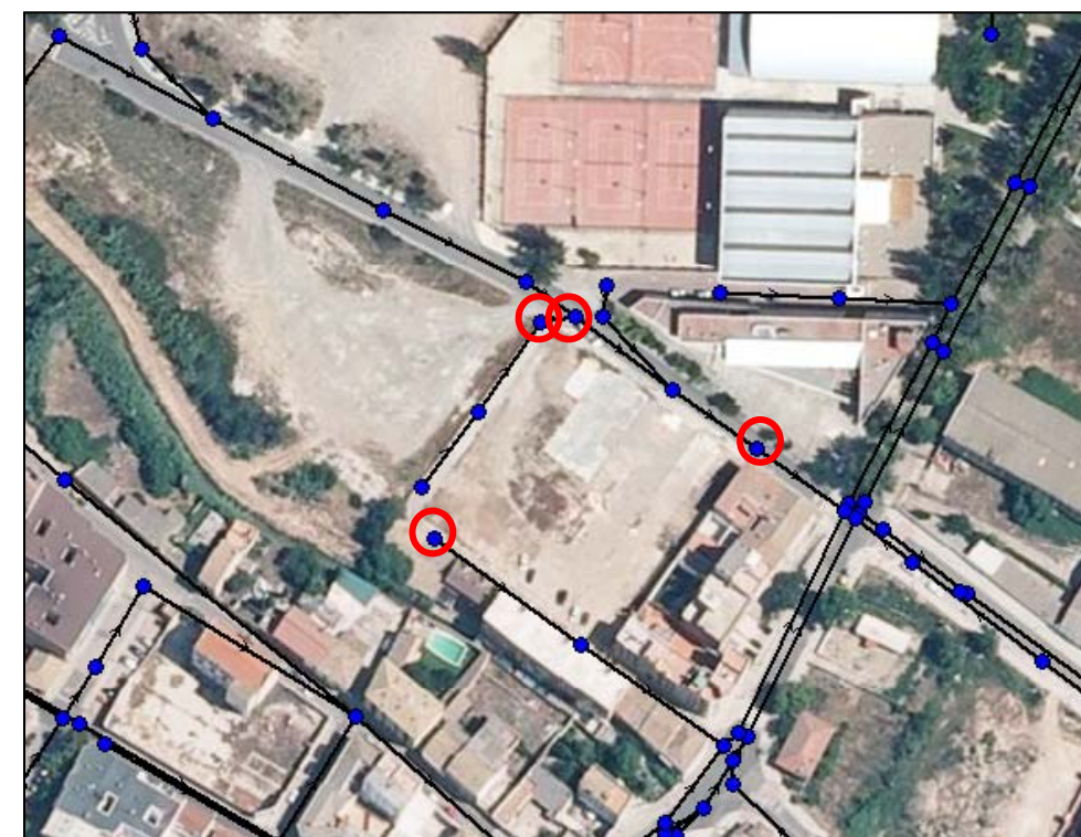
Figura: Redondeados en rojo, los pozos que entran en carga y expulsan agua a través de los sumideros cercanos.
